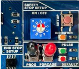
L'interrupteur automatique protège le système contre d'éventuels oublis de déverrouillage des kits d'accrochage, lors de l'ouverture du bassin.
