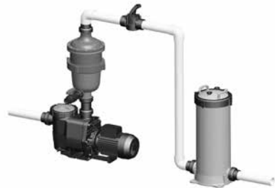
Usuale installazione con un filtro a cartucce
