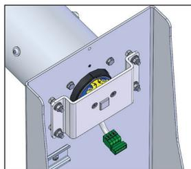
Faire des petits mouvements de rotation avec le moteur afin de faciliter l'encastrement du moteur.
